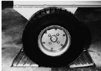
Abbildung: Fahrgestell einkeilen
