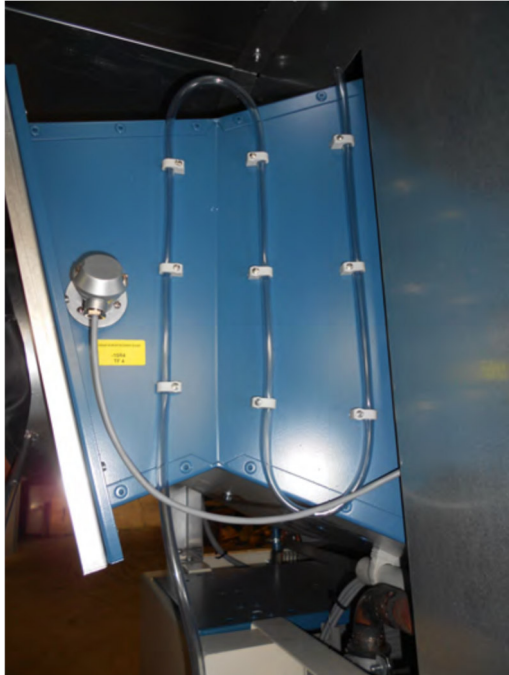
Abbildung: Messung des Gesamtgegendruckes
