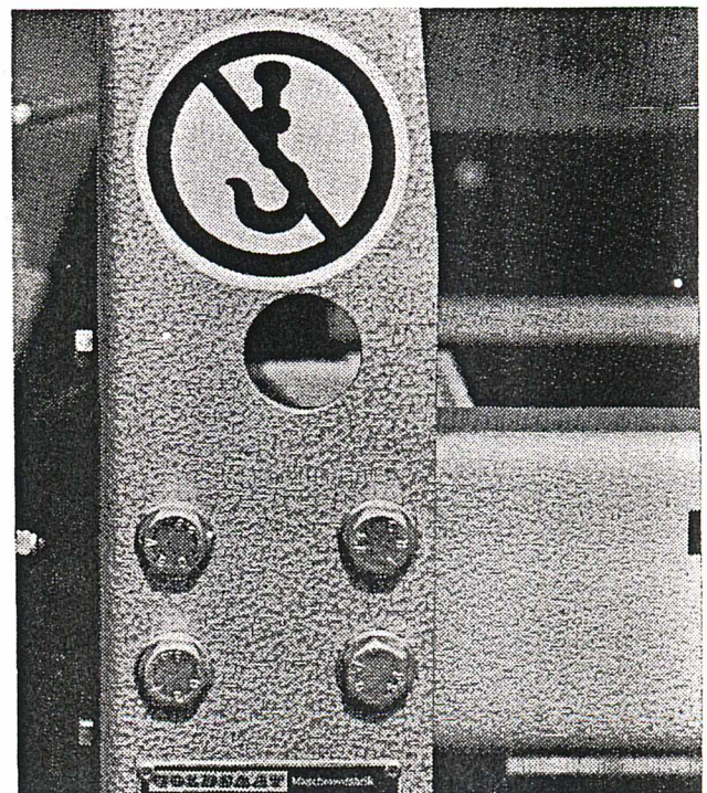
Bild 1: Befestigungsöse ⑨. Diese ösen dienen nicht zum Anheben der Geräte!
